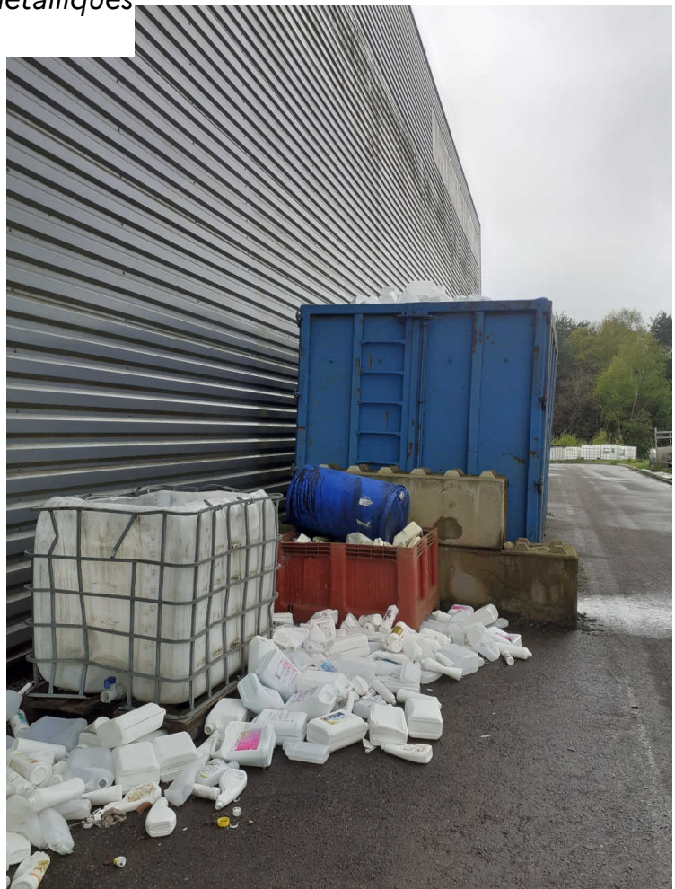
Figure 4: Déchets de bidons de produits chimiques stockés hors rétention et exposés aux intempéries
