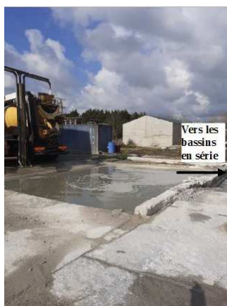
Photographie 3. Plateforme de lavage des toupies et récupération des eaux
