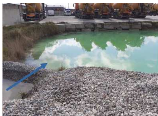
Photographie 3. Plateforme de lavage des toupies et récupération des eaux
