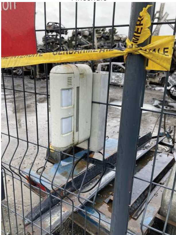
Type de détecteur de présence retrouvé fondu le long de la clôture – lieu de départ de l'incendie
