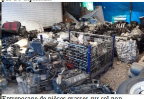
Entreposage de pièces grasses sur sol non imperméabilisé et sans emballage étanche
