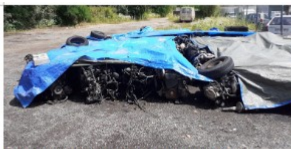
Moteurs stockés en plein air sur un sol non imperméabilisé en extérieur et une parcelle n'appartenant pas à l'exploitant
