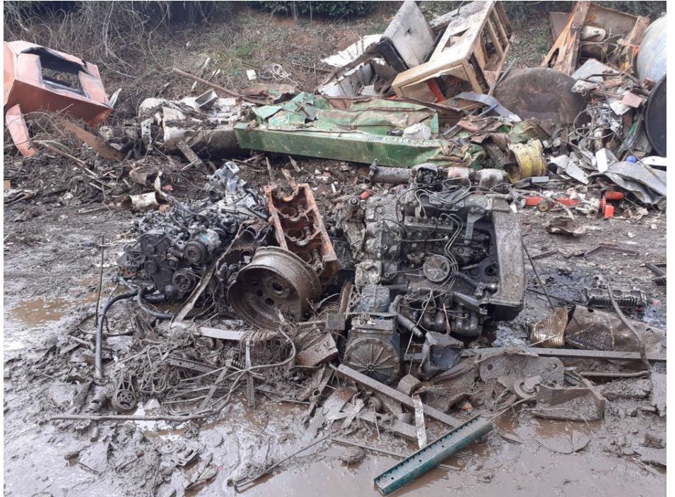
Figure 3: Moteurs stockés hors rétention et sans abri vis à vis des eaux de pluie
