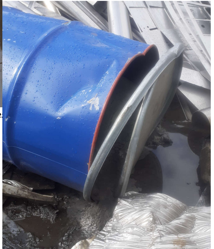
Figure 2: Fût contenant des poudres métalliques renversés et trempant dans les eaux pluviales
