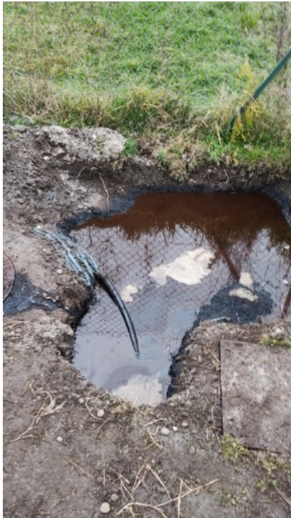
traces d'hydrocarbures sur une zone non étanche
