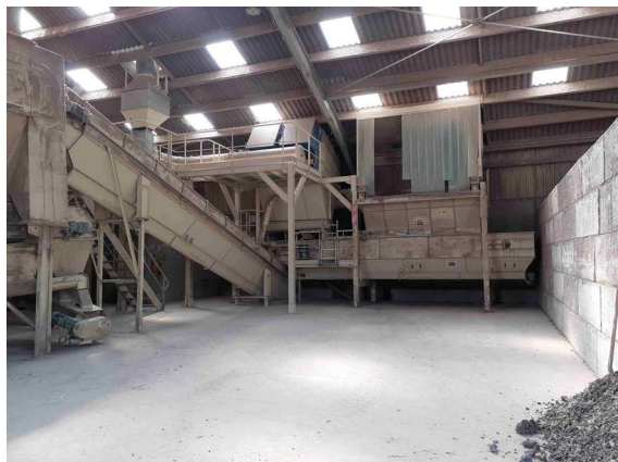
lanières souples abîmées ou manquantes sur la trémie
