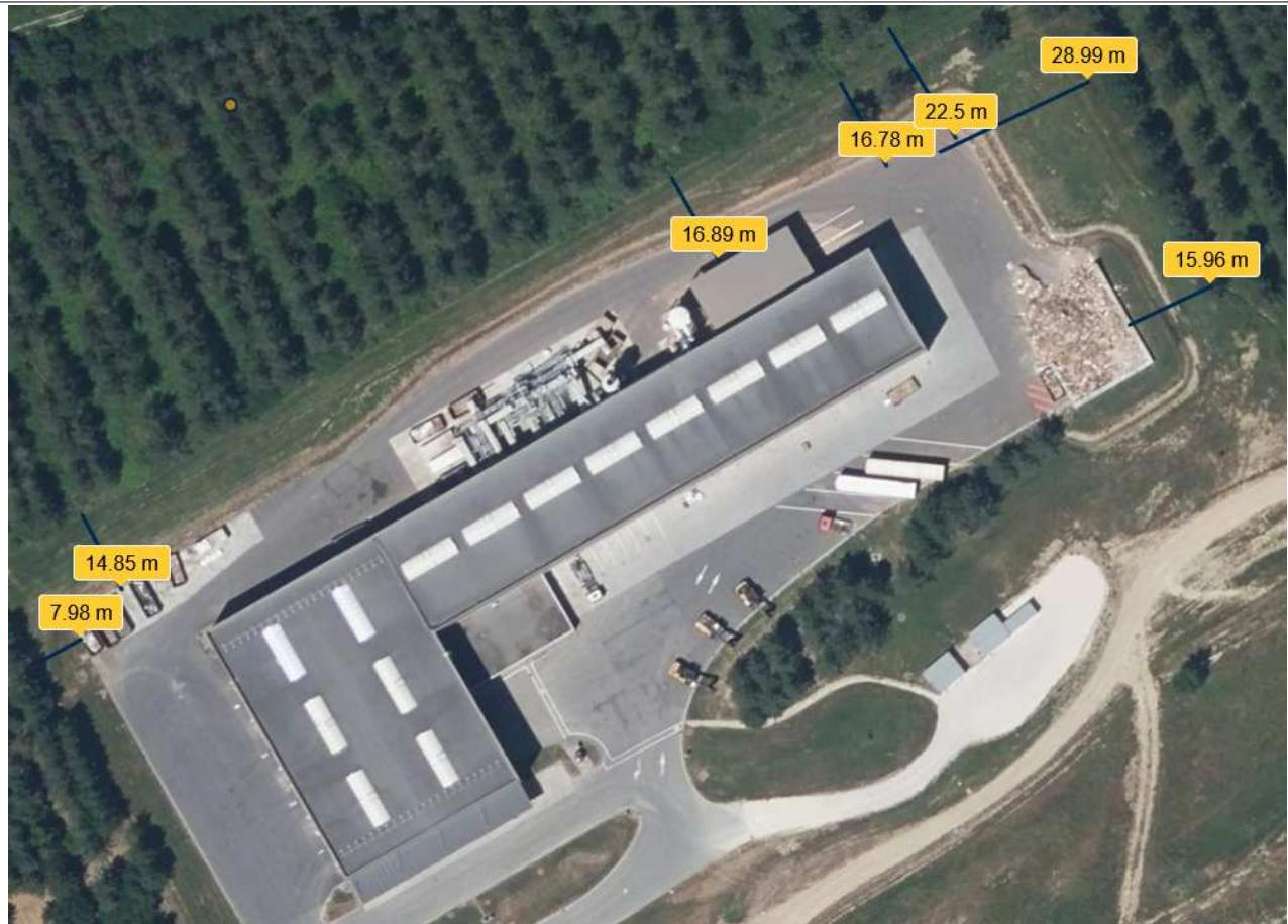
L'exploitant indique que le choix a été pris de mettre cette semi-remorque à cet endroit en raison de la présence d'un poteau incendie sur-pressé à moins de 15 m du véhicule (couplé à un canon incendie), et du déploiement d'un robinet incendie armé (RIA).
