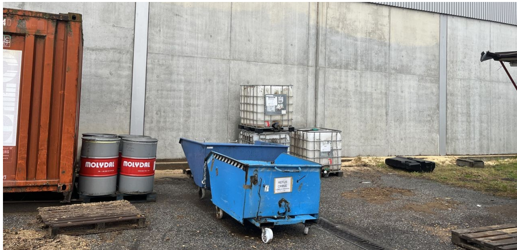
Déplacement des IBC souillé sur zone étanche, raccordé à un déshuileur.
